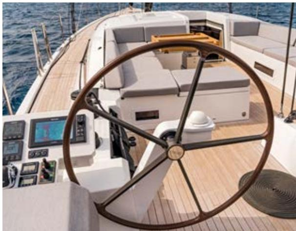
■ Pour les plus esthètes : une barre à roue en teck lamellé-collé, rayons carbone.
